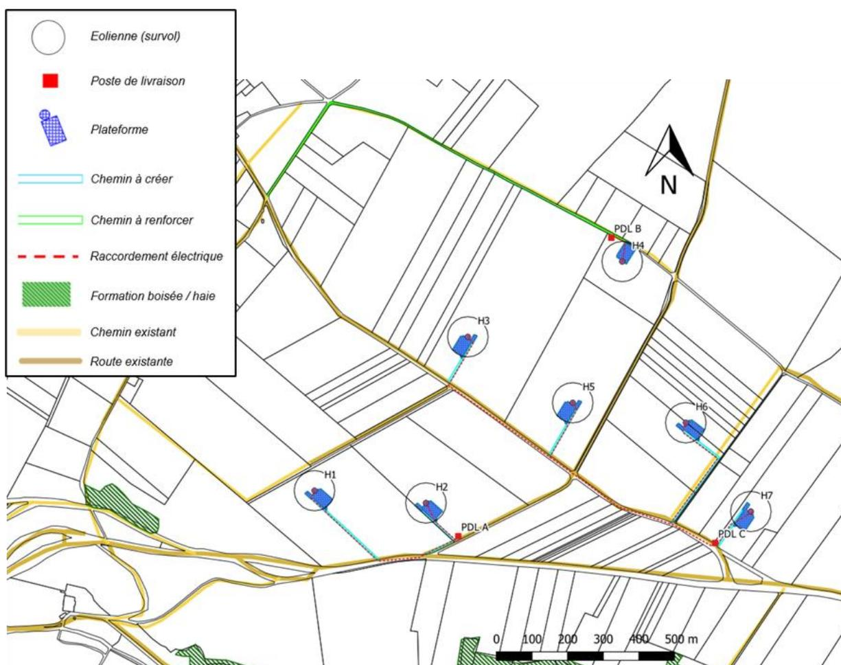
FIGURE 5 : PLAN D'IMPLANTATION DES EOLIENNES AVEC CHEMIN D'ACCES ET POSTES DE LIVRAISON
