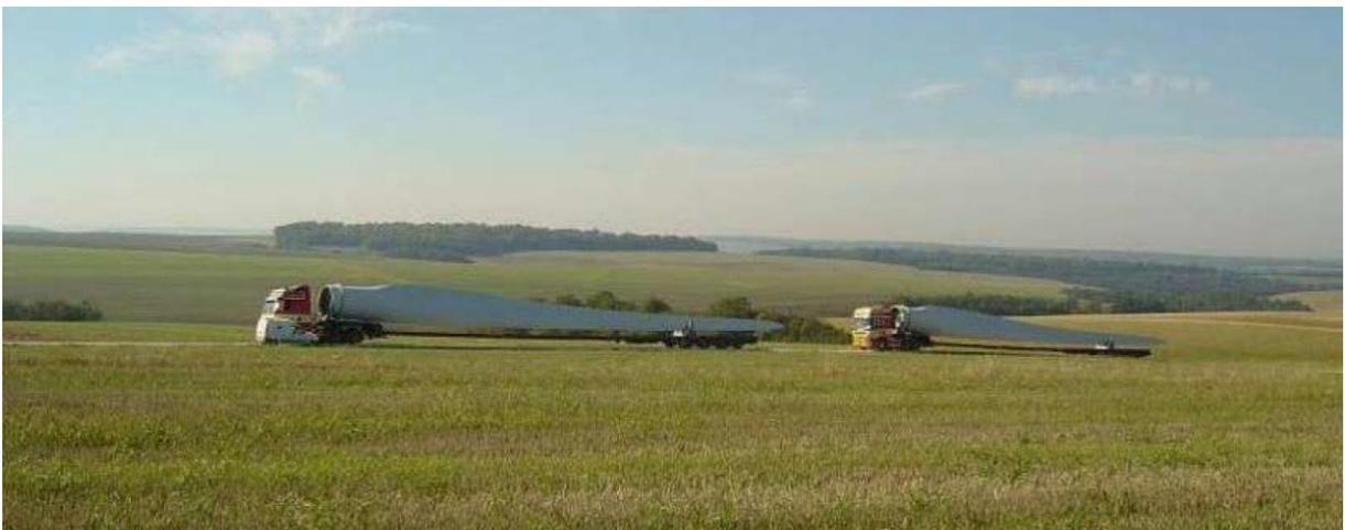
FIGURE 22 : EXEMPLE DE TRANSPORT DE PALE PAR CAMION
